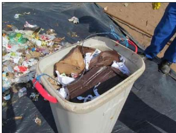
Foto 139. Registro fotográfico do método de quarteamento realizado no Aterro Controlado de Araguaína/TO.
