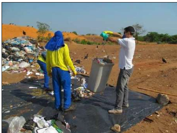
Foto 139. Registro fotográfico do método de quarteamento realizado no Aterro Controlado de Araguaína/TO.
